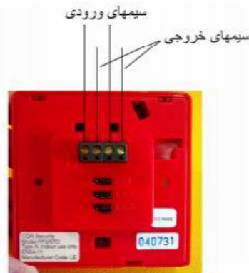
سیمهای اتصال شستی اعلام حریق
